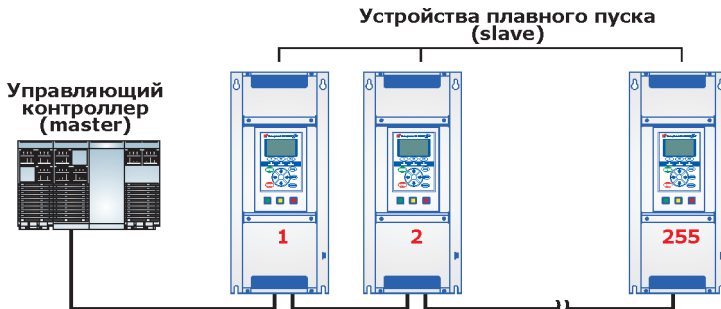
Рисунок 1 - Пример построения сети RS-485
